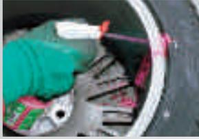
**Sprühen: Die Mittel werden in den Innenseiten aufgebracht**
